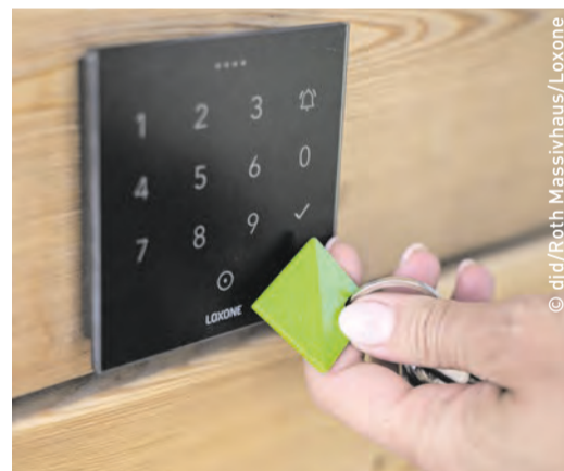
Auch die Türsteuerung kann „smart“ per NFC-Code gelöst werden. In Kombination mit weiteren Smarthome-Geräten entsteht so ein umfassendes, sicheres Zutrittssystem.
